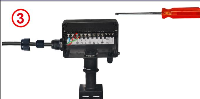
**3** : Вставьте провод заземления в клемму заземления и затяните винт. Рекомендуемый момент 1,6 Нм.
