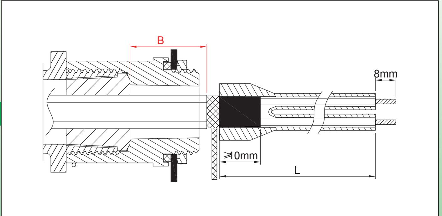
Расстояние **B** должно быть минимальным, чтобы избежать нагрева внутренней поверхности шкафа. Длина **L** зависит от расстояния до соединительных клемм.
