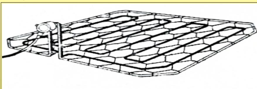
1956 г, пример решетки площадью 1,5 м<sup>2</sup>, поддерживающей нагревательный элемент с оболочкой, для обогрева слоев в садоводстве. (1956 г. Электрическое отопление в садоводстве, музей Ultimheat\*)
