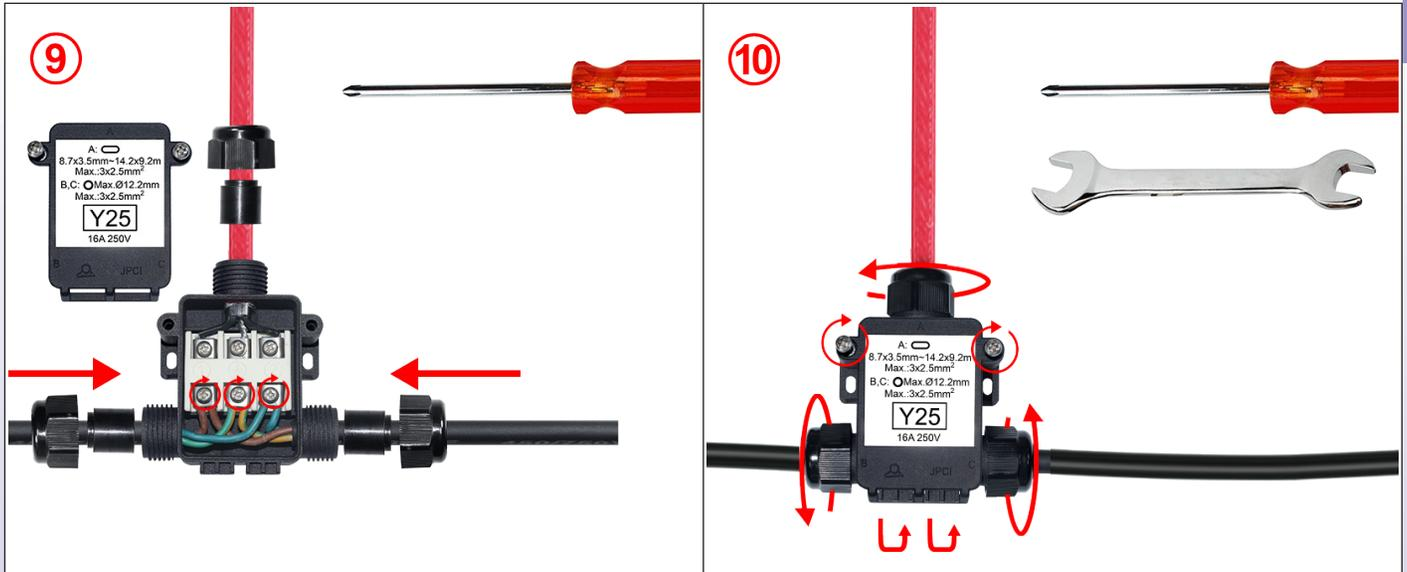
9 : Вставьте зачищенную часть проводников питания в клеммы и затяните отверткой. По 2 проводника внутри каждой клеммы, с каждой стороны седла. Рекомендуемый момент затяжки: 1,2 Н.м.
