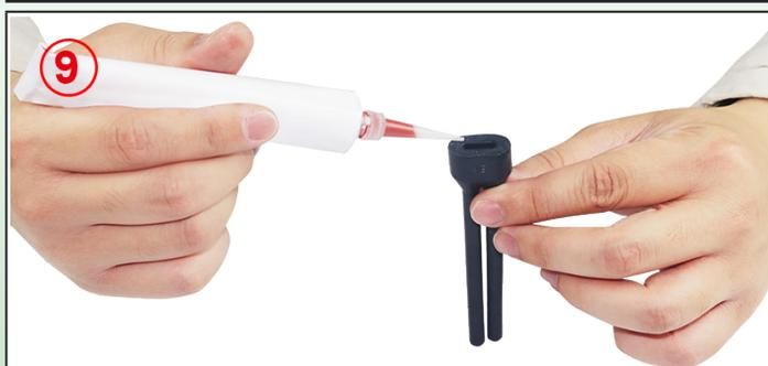
**9:** Залейте силикон RTV внутрь основного отверстия силиконового наконечника.
