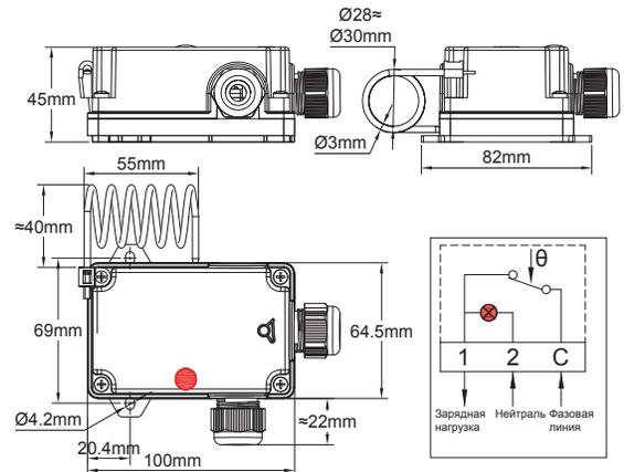
Пример настенного монтажа модели, подключенной к соединительным коробам Y25 для защиты от замерзания животноводческих водоемов
