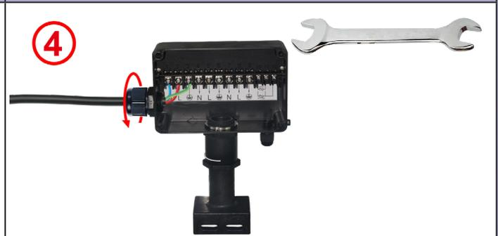
**4** : Вставьте круглую прокладку кабеля в кабельный ввод и затяните гайку. Максимальный момент 6 Н.м.
