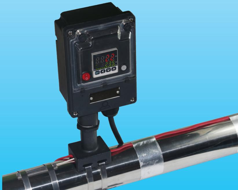
Пример монтажа на трубе
