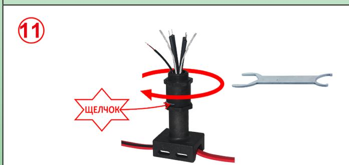
**11:** Сожмите уплотнение, закрутив верхнюю часть ножки. По окончании затяжки маленькая пружинка блокирует сборку (для демонтажа необходимо снять эту маленькую полукруглую пружинку). Затем можно установить эту ножку в отверстие диаметром 32,5 мм на выбранном корпусе.
