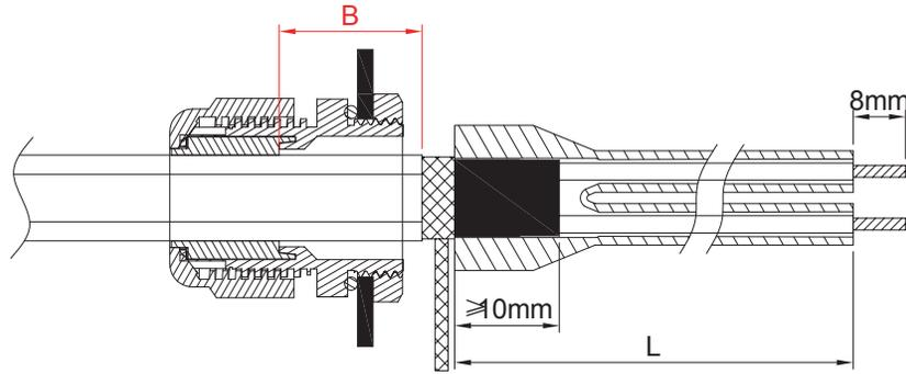
Расстояние **B** должно быть минимальным, чтобы избежать нагрева внутренней поверхности шкафа. Длина **L** зависит от расстояния до соединительных клемм.
