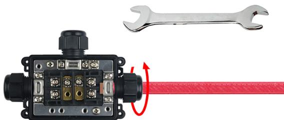
11 : Вставьте плоскую прокладку кабеля в кабельный ввод и затяните гайку. Максимальный момент 3 Н.м. Подключите все остальные кабели и закройте крышку.
