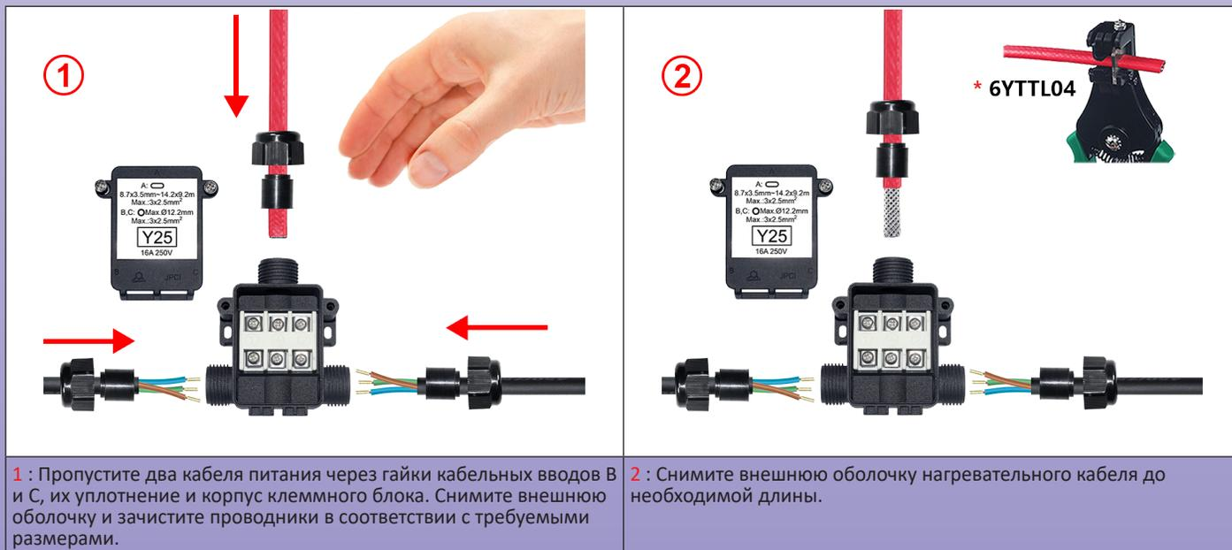
**1** : Пропустите два кабеля питания через гайки кабельных вводов В и С, их уплотнение и корпус клеммного блока. Снимите внешнюю оболочку и зачистите проводники в соответствии с требуемыми размерами.
