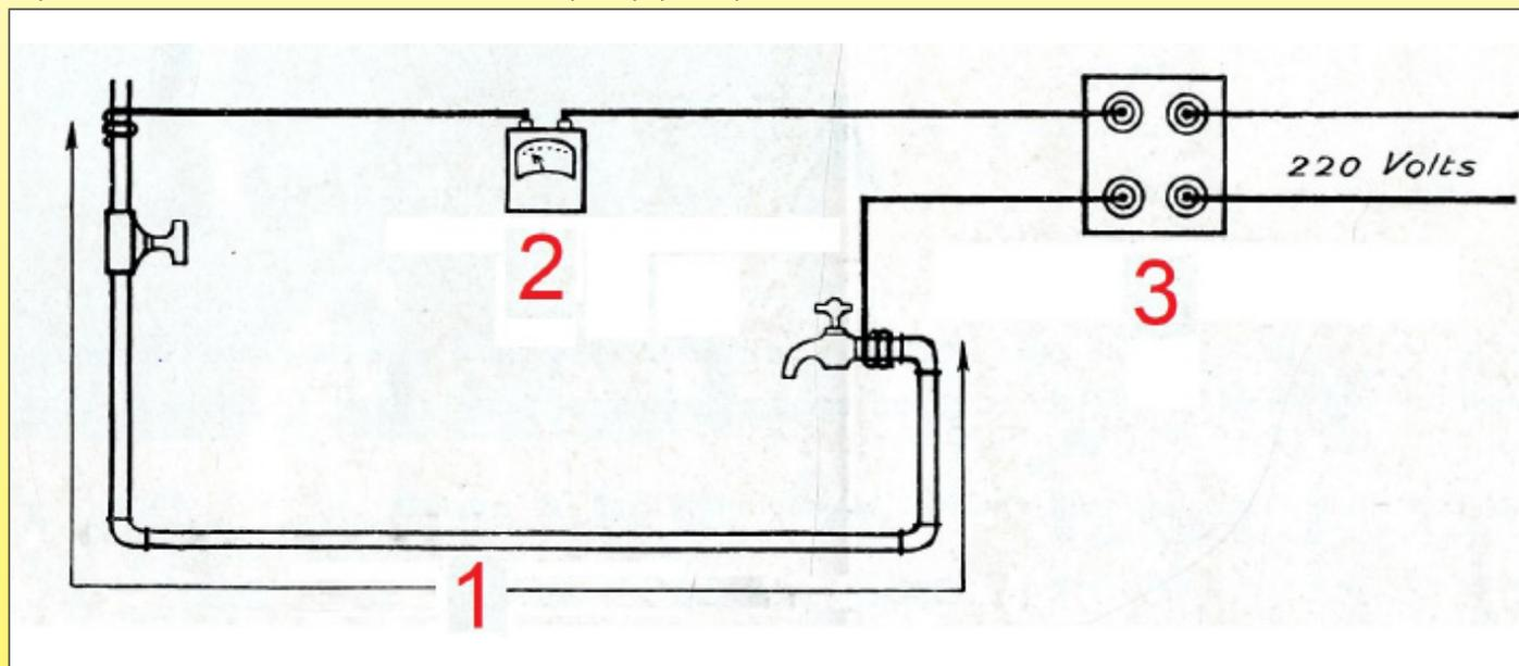
Система размораживания водопроводных труб, реализованная Сундговским обществом электрических сил в 1928 году
