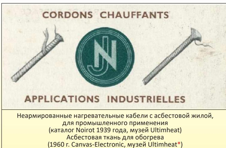
Другим важным применением являются нагревательные шнуры, состоящие из калиброванной асбестовой бусины, на которую намотан металлический проводник и покрыт (или нет) асбестовой оплеткой или другими изолирующими веществами". (1966 Электрические нагревательные элементы, музей Ultimheat\*)
