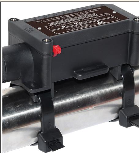
2: Два съемных пластиковых выступа из РАББ для установки на трубах, обеспечивающие смещение от трубы на 10 мм. Идеальный и экономичный вариант для применения в системах с малой толщиной изоляции и температурой труб ниже 100°C. Зажим на металлическом или PVC-трубопроводе может осуществляться нейлоновой стяжкой или металлическим хомутом (эти выступы входят в стандартную комплектацию).
