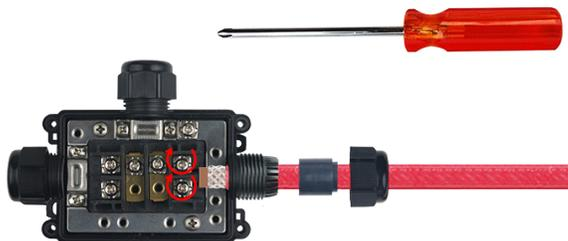
9 : Поместите шинный провод и оплетку в место, где они будут затянуты. Затяните винты клеммной колодки на проводах шины. Рекомендуемый момент 1,2 Нм.
