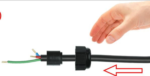
1 : Снимите внешнюю изоляцию с круглого кабеля в соответствии с чертежом. В самом конце нужно обжать кабельный башмак. Наденьте гайку кабельного ввода на кабель. Выберите прокладку совместимого диаметра и наденьте ее на кабель.
