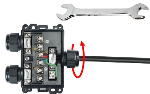
4 : Вставьте круглое кабельное уплотнение в кабельный ввод и затяните гайку. Максимальный момент 3 Н.м.
