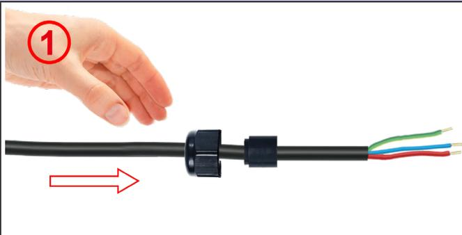
**1** : Снимите внешнюю изоляцию с круглого кабеля в соответствии с чертежом. В самом конце нужно обжать кабельный башмак. Наденьте гайку кабельного ввода на кабель. Выберите прокладку совместимого диаметра и наденьте ее на кабель.
