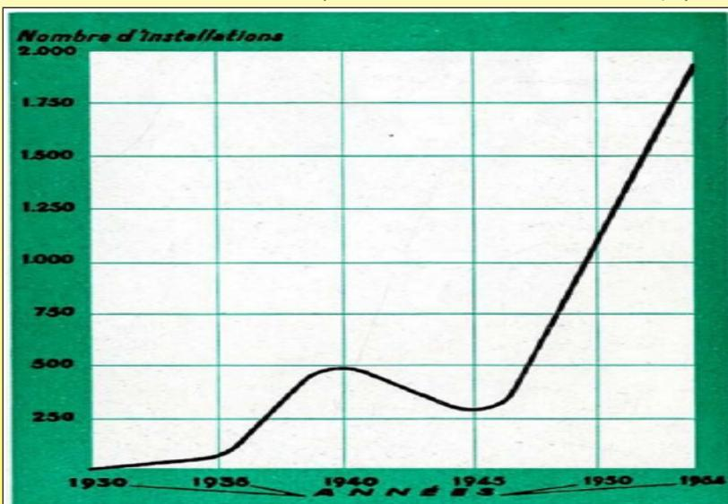
Изменение количества грунтовых тепловых установок, находящихся в эксплуатации с 1930 г.
