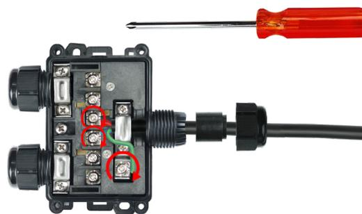
2 : Поместите нулевой, линейный и заземляющий провода в винтовые зажимы и закрепите их. Рекомендуемый момент 1,2 Нм.
