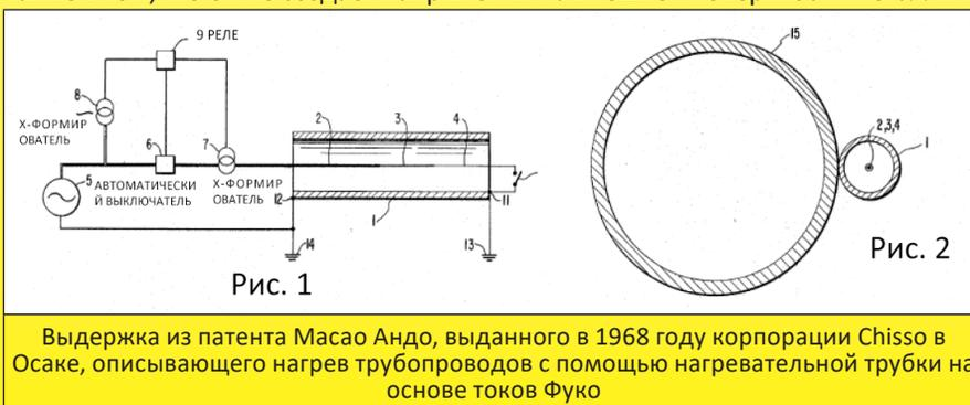
Выдержка из патента Масао Андо, выданного в 1968 году корпорации Chisso в Осаке, описывающего нагрев трубопроводов с помощью нагревательной трубки на основе токов Фуко
