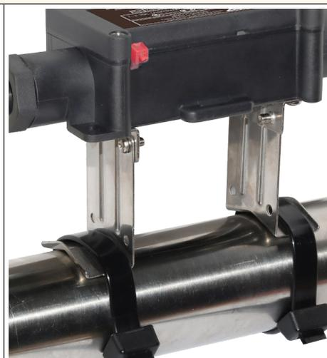
3: Один кронштейн из нержавеющей стали, для установки на трубопроводе со смещением, позволяющий зафиксировать корпус после установки изоляции и ее защиты. Допускает толщину изоляции 50 мм и может применяться на горячих трубах. Зажим на металлическом или PVC трубопроводе с помощью нейлоновой стяжки или металлического хомута. (Ножки поставляются в качестве аксессуара.)
